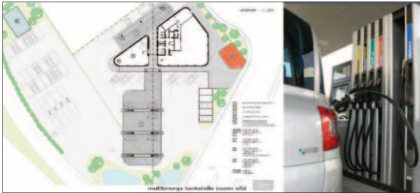
Figura 2. Moderna stazione di rifornimento multi-combustibile (benzina, diesel, metano, biometano, miscele metano-idrogeno) dotata di dispositivi self-service e multi dispenser
